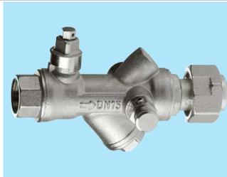
È una valvola monoblocco che comprende, in ordine da monte a valle, una valvola di intercettazione a sfera, l'unità di filtraggio e l'attacco per il manometro. La cartuccia filtrante è sostituibile. È destinato al raccordo della rete d'utenza dell'acquedotto prima del contatore. PN 16, Ø 1/2", in ottone EN 12165.
