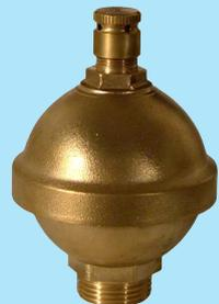
La valvola di sfiato aria tipo "ROMA" è una valvola automatica a singolo galleggiante, utilizzata per l'evacuazione e lo scarico di grandi quantità d'aria dalle tubazioni per il trasporto di acqua. In questa applicazione si utilizza il diametro di 1". Le pressioni di esercizio massime sono di PN 16.
